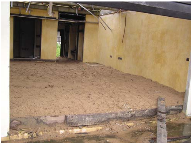
รูปที่ 6 ใช้ทรายในการเพิ่มน้ำหนักบรรทุก
