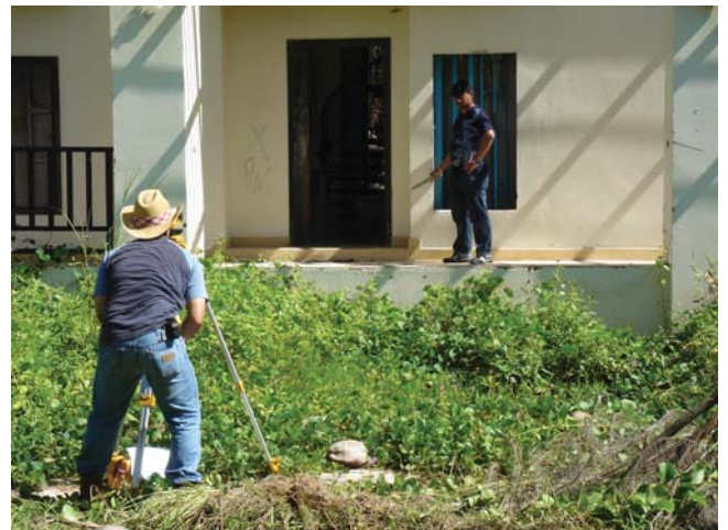
รูปที่ 7, 8 การสำรวจเพื่อวัดค่าการทรุดตัวของอาคาร ระหว่างการทดสอบน้ำหนักบรรทุก
